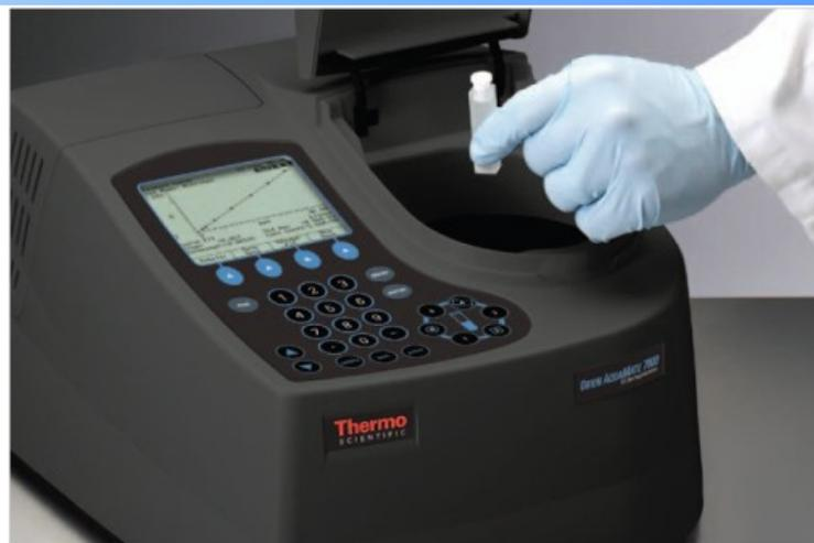
Los instrumentos AquaMate cuentan con tres puertos USB, proporcionando las opciones para almacenar métodos y datos a un dispositivo de memoria USB, transferir datos a una computadora e imprimir los datos por medio de una impresora externa. Los instrumentos son compatibles con impresoras ink jet y láser con HP PCL 5 o mayor.
