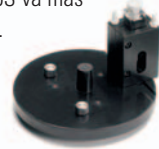
Portaceldas sencillo termostatzado por circulación de líquido
